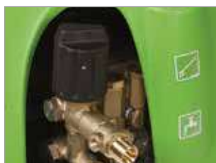
BOUTON POUR LE RÉGLAGE DE LA PRESSION
