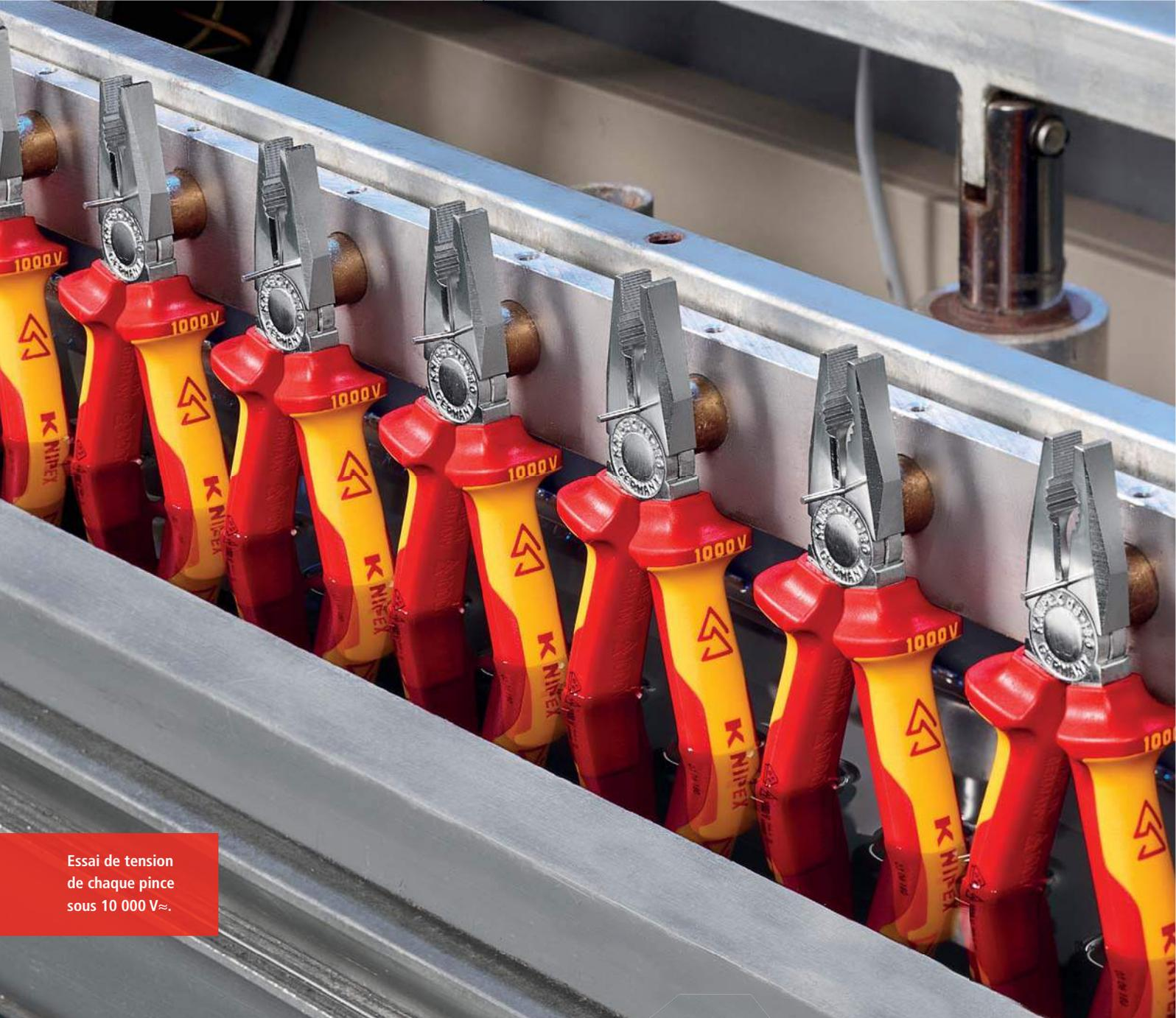
Essai de tension
