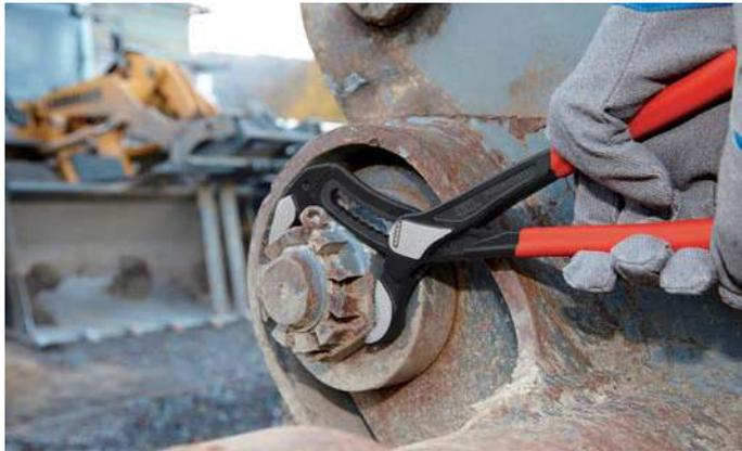
La pince KNIPEX Alligator® XL fournit la performance et le confort d'une pince multiprise à moitié moins lourde qu'une clé serre-tubes comparable disposant d'une capacité de préhension plus élevée (3 1/2"). D'une longueur pratique de 400 mm, la KNIPEX Alligator® XL trouve sa place dans toutes les caisses à outils.
