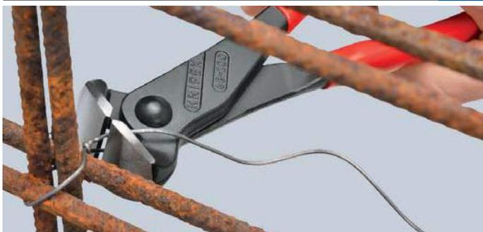
Forme de la tête permettant d'optimiser les mouvements lors du serrage du nœud au ferrailage
