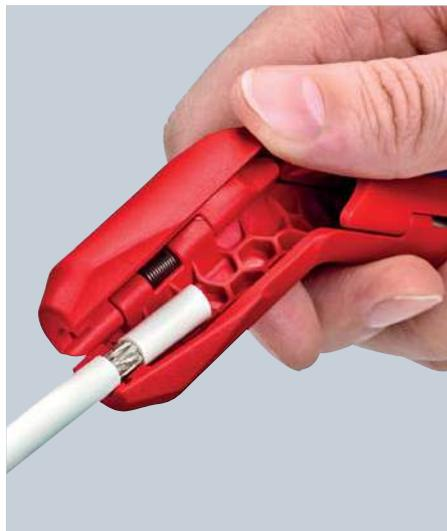
Dégainage d'un câble coaxial
