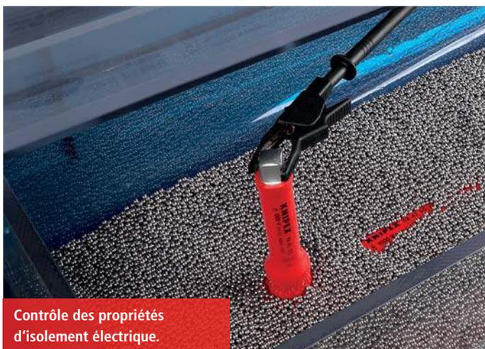
Contrôle des propriétés d'isolement électrique.
