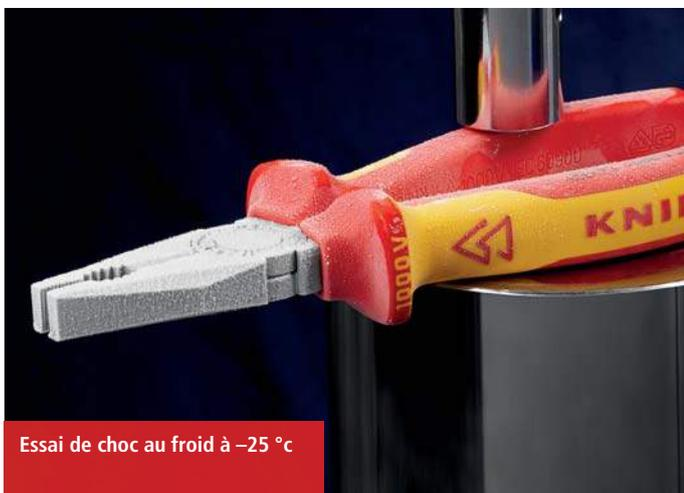
Essai de choc au froid à -25 °c
