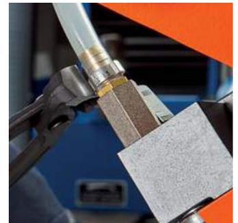
Étanher raccord de tuyau au graissage central
