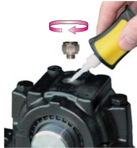
Vissage du raccord de réduction (si nécessaire, étanchéiser le point de graissage)
