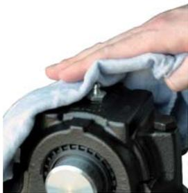
Nettoyage du point de graissage
