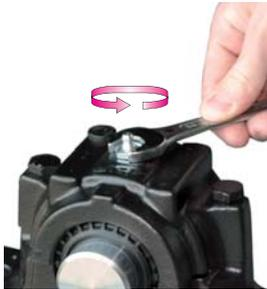
Retrait du raccord de graissage
